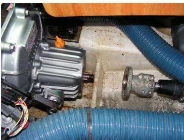
Oben und rechts: Eine schlampige Reparatur ist die Ursache für den Ausfall des Antriebes – statt eines mechanischen Keils übernimmt eine Kerbe in der Mutter den Formschluss!
