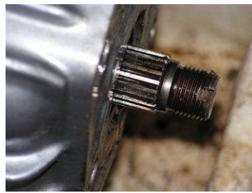
Oben und rechts: Eine schlampige Reparatur ist die Ursache für den Ausfall des Antriebes – statt eines mechanischen Keils übernimmt eine Kerbe in der Mutter den Formschluss!
