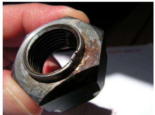
Oben und rechts: Eine schlampige Reparatur ist die Ursache für den Ausfall des Antriebes – statt eines mechanischen Keils übernimmt eine Kerbe in der Mutter den Formschluss!
