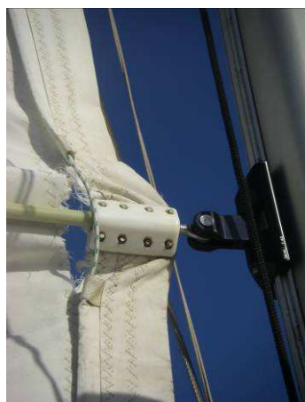
Links: Riss im Großsegel
